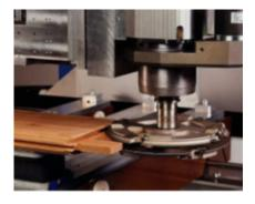
"CAROUSEL" TYPE TOOL MAGAZINE WITH 16 POSITIONS FOR AUTOMATIC TOOL CHANGE.
