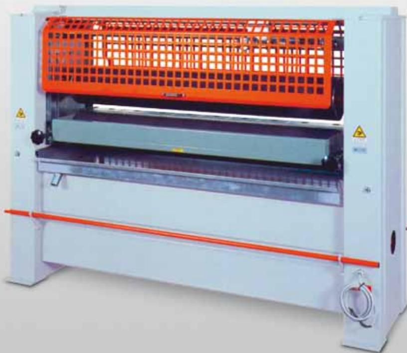
**RODILLOS DE DISTRIBUCIÓN DE COLA** revestidos en goma especial anti-acido; son rectificadas y arrugadas, resistentes al desgaste, están construidos con un racional estrato de goma; es posible por lo tanto ejecutar hasta 6/7 rectificaciones. Se pueden desmontar en modo fácil y rápido.
